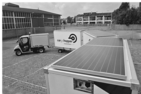
zonnepanelen op dak van laadbakken
